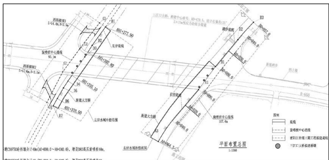
图3.3-7 本工程堤防加固防渗补偿示意图
