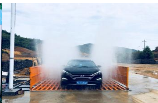
图 7 车辆自动冲洗装置示意图
