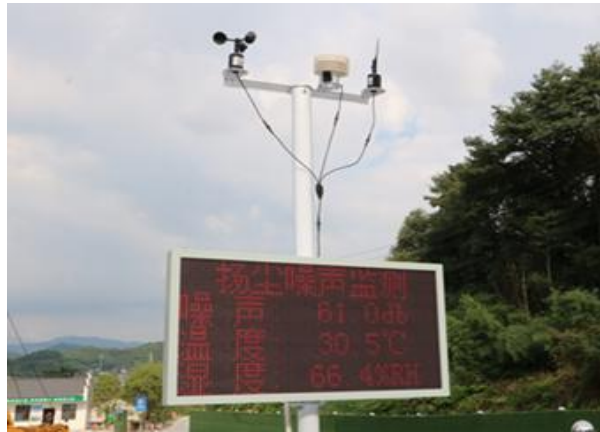
图 1 扬尘噪声在线监测系统示意图
